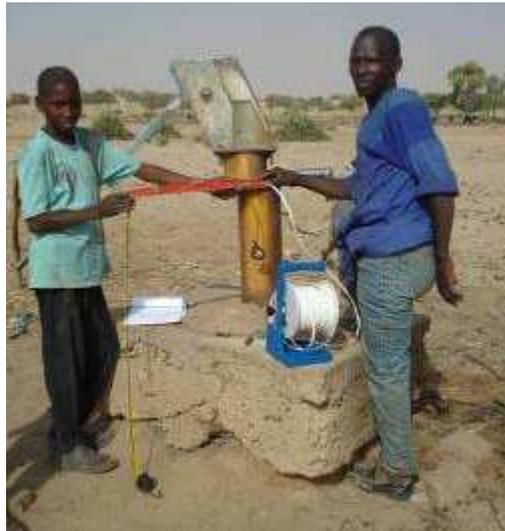
**Photo (s) 2: Opérateur en train de mesurer le niveau d'une nappe phréatique avec une sonde piézométrique**
